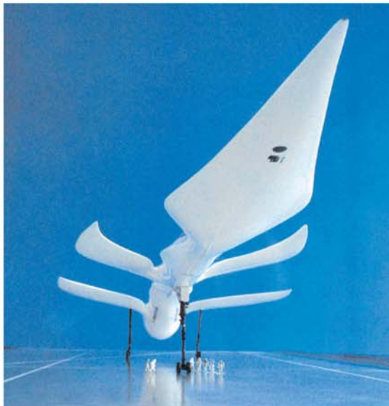
Studie aus dem Jahre 1983 für den „Mach 5“-Passagierflieger, der die Strecke von Tokio nach London in drei Stunden hätte schaffen sollen.
